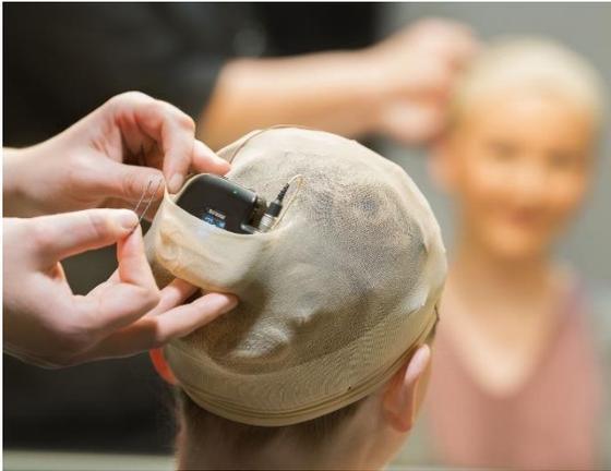
*Abb. 1: Taschensender in einer Perücke eingearbeitet (Quelle Shure)*
