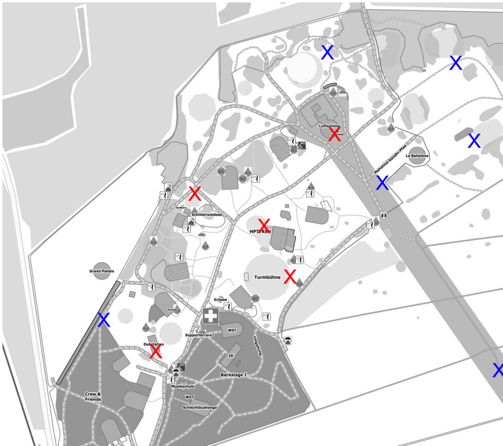
Abbildung 4.3: Mobile Messpunkte der Schallpegelmesscrew (blau) und stationäre Messpunkte an den FOHs (rot)
