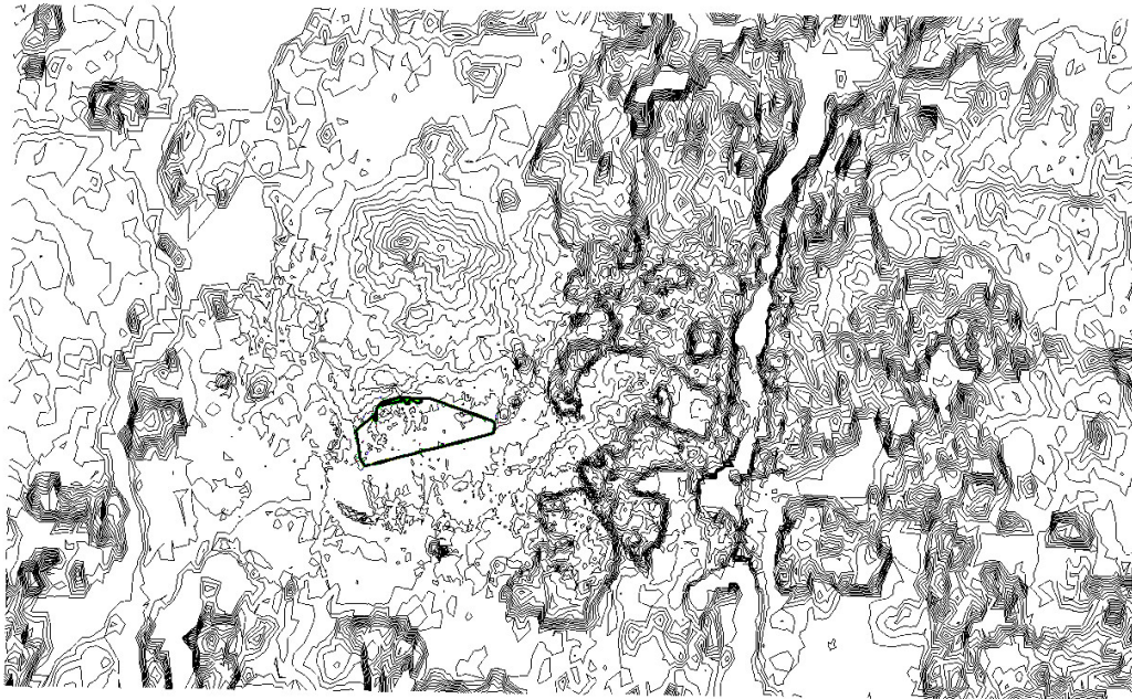
Abbildung 3.3: Digitales Geländemodell aus Soundplan mit Höhenlinien. Abgebildet wird ein Gelände von etwa 15 km auf 9 km mit Höhenlinien mit 2,5 Metern Differenz. Dick eingezeichnet sind die Außengrenzen der Fusion.
