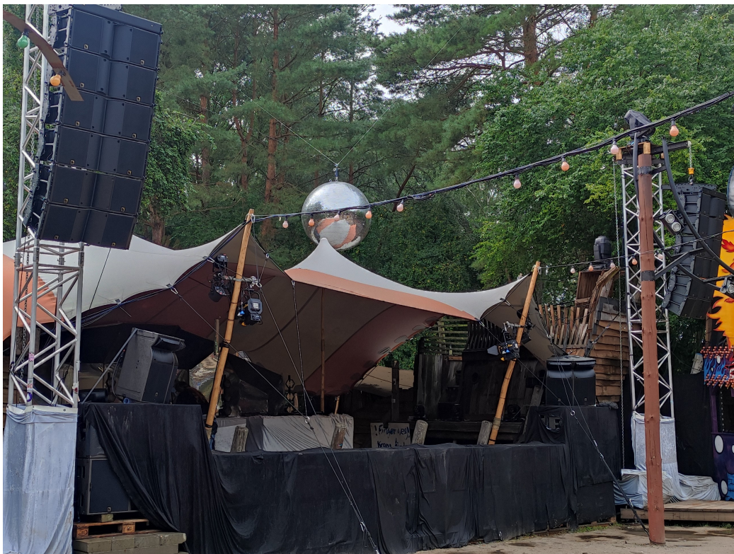
Abbildung 3.8: Seebühne auf dem Plan:et C mit zwölf K3, 14 KS28 und vier A15 von L'Acoustic
