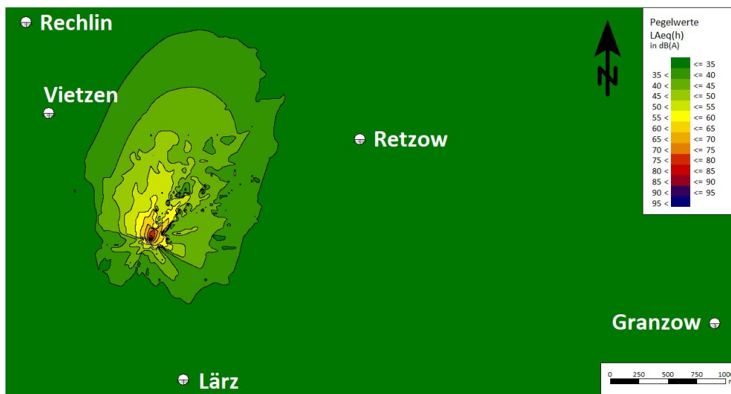
Abbildung 5.7: Rasterlärmmkarte des KuKo-Geländes mit umliegenden Immissionsorten nach DIN 9613-2 von Sonntag 29.08.2021 13:00-14:00 Uhr
