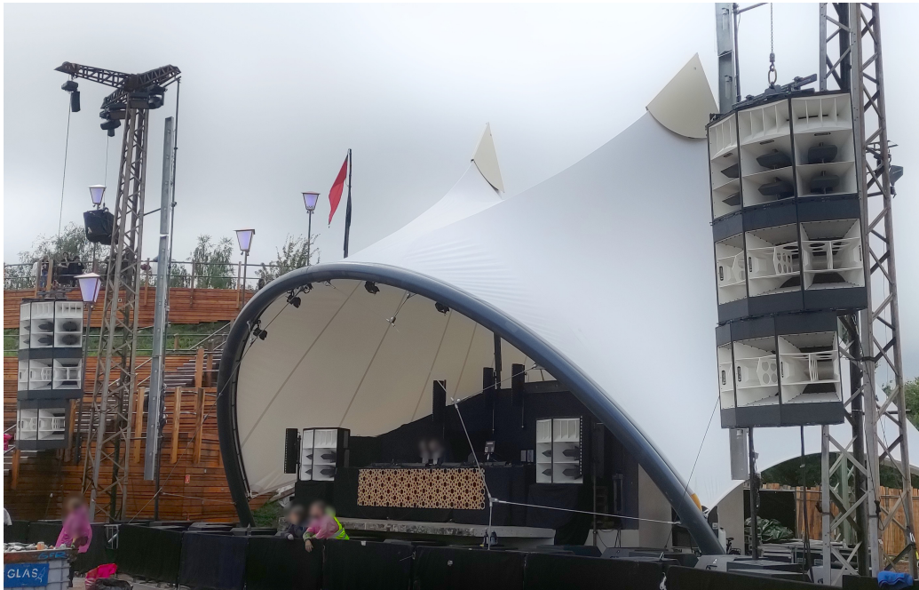
Abbildung 3.10: Turmbühne mit Anlage von Lambda Labs mit 2 QX-3, 35 DH-18 und dem Nearfill
