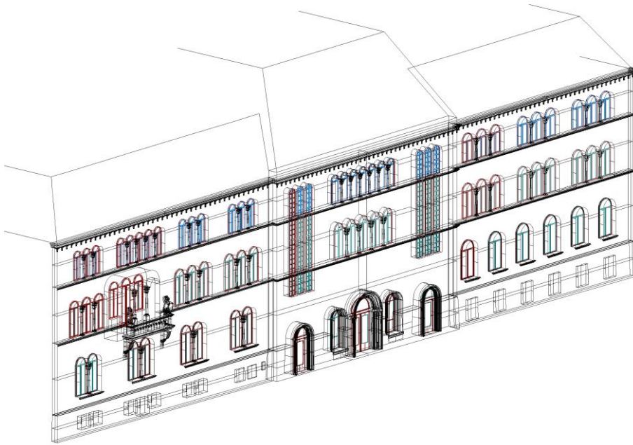
Abbildung 47: Beispiel für ein 3D-Modell einer Fassade, dargestellt als Drahtkörper Motiv: Notenbank Weimar Quelle: Zeichnung zur Verfügung gestellt von device+context
