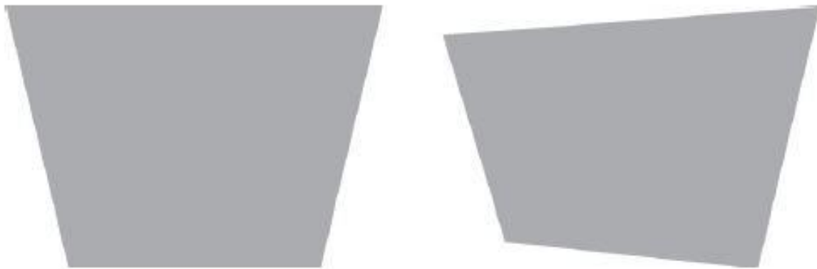
Abbildung 28: Links: Resultierendes Bild aufgrund von vertikaler Neigung des Projektors, rechts: Resultierendes Bild aufgrund von zusätzlich seitlicher Schrägprojektion Quelle: Ebner, M. (2019) Live Videotechnik, Projektion, Streaming, Aufzeichnung, Berlin: Beuth Verlag GmbH, S.175
