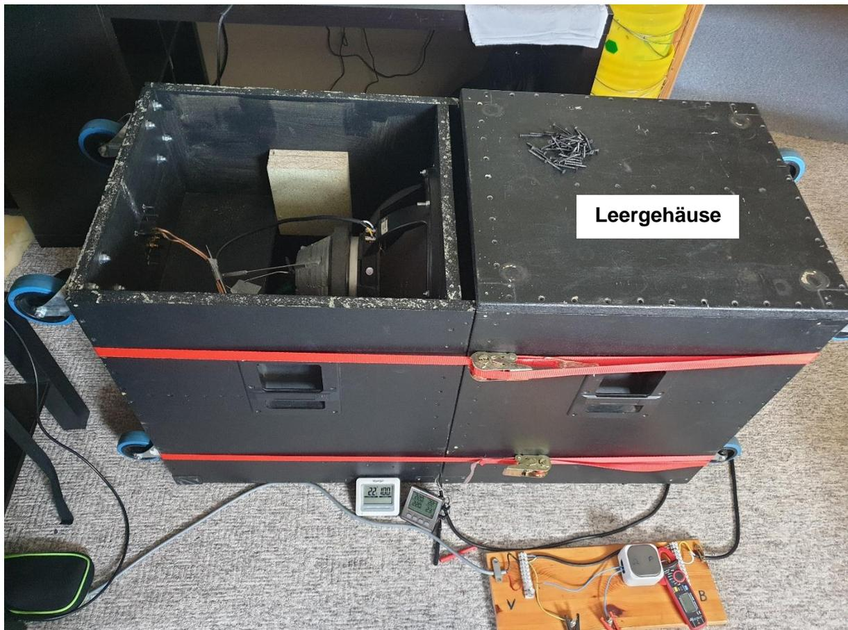
Anhang Abbildung 13: Anordnung der Gehäuse mit Einblick in den zu untersuchenden Lautsprecher [Eigene Darstellung]. Während den Temperaturuntersuchungen waren beide Gehäuse geschlossen.
