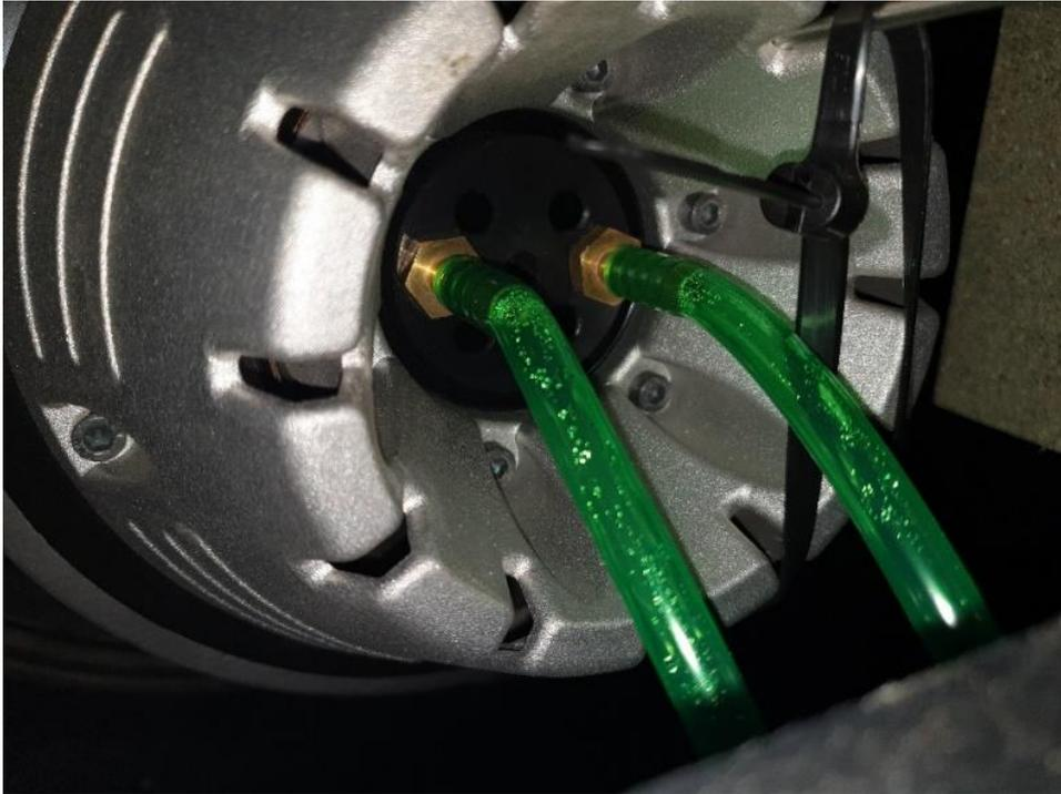
Abbildung 14: Eingebaute Wasserkühlung mit aufgestecktem PVC-Aquarienschlauch jeweils für den Zu- und Ablauf (der Kabelbinder ist nicht Teil des Wasserkühlsystems) [Eigene Darstellung].
