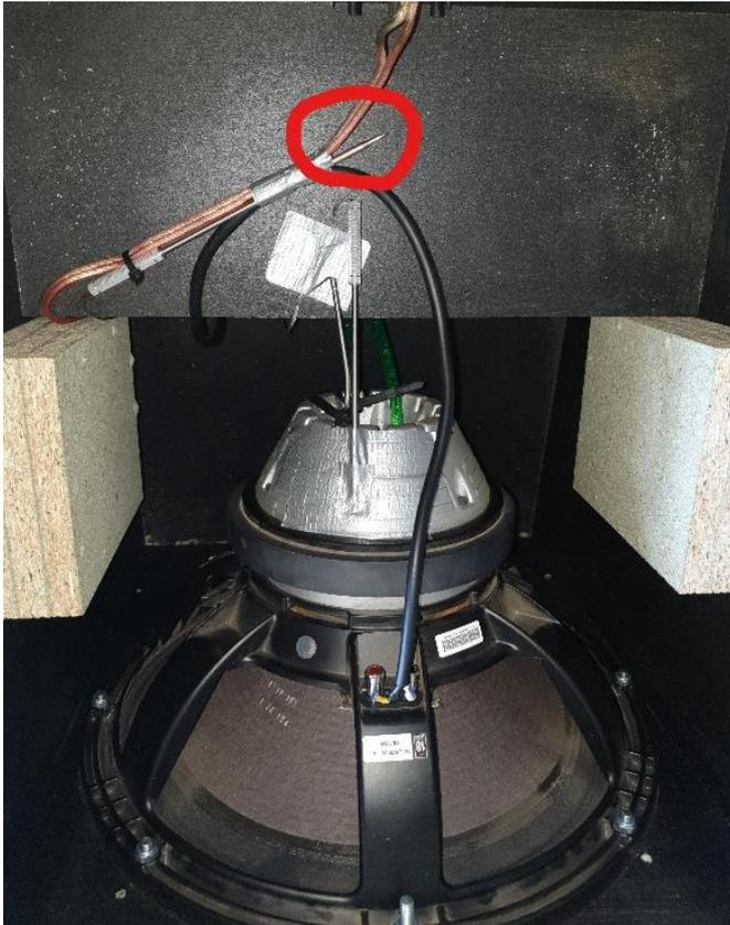
Anhang Abbildung 2: Gehäusetemperatur ( $T_{\text{Gehäuse}} [^{\circ}\text{C}]$ ) [Eigene Darstellung] - Für die Ermittlung der Gehäusetemperatur wurde die Messsondenspitze (rot umkreist) möglichst zentral und mittig im Subwoofer-Gehäuse positioniert, da hier die Gehäusedurchschnittstemperatur zu erwarten ist.
