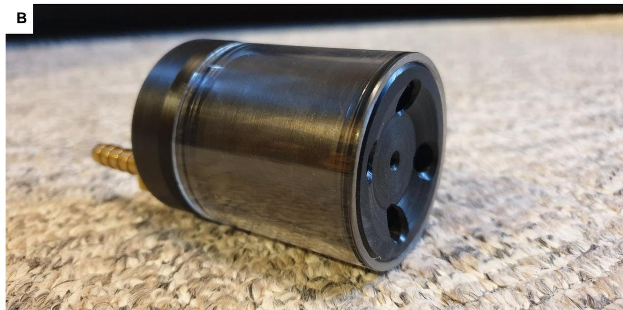
Anhang Abbildung 12: Plexiglasrohr mit Polkerndurchmesser für Testversuche [Eigene Darstellung]. (A) – Plexiglasrohr und Wasserkühlung einzeln. (B) – Plexiglasrohr verbunden mit der Wasserkühlung.
