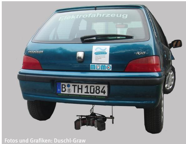
Mithilfe eines integrierten Bilderkennungssystems wird der Sekundärkreis des Trafos beim Laden automatisch auf dem Primärkreis positioniert und nach erfolgter Authentifizierung mittels RFID-Kennung werden der Lade- und der Abrechnungsvorgang automatisch gestartet.
