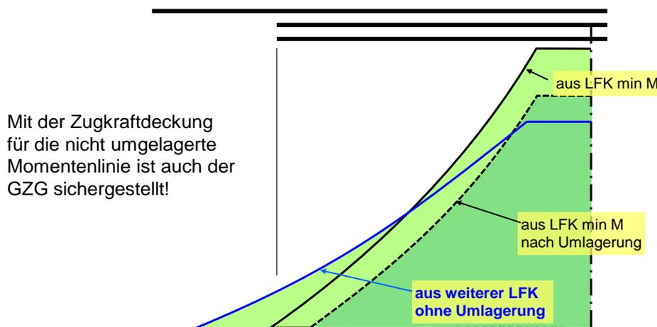
Bild 13-8 Zugkraftdeckung bei Momentenumlagerung
