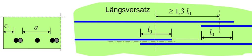
Bild 12-9 Beiwerte  $\alpha_6$  und längsversetzter Stoß
