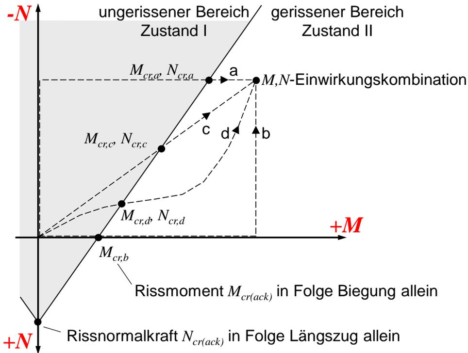
Bild 11-5 Risschnittgrößen bei einer Kombination aus Biegung und Normalkraft
