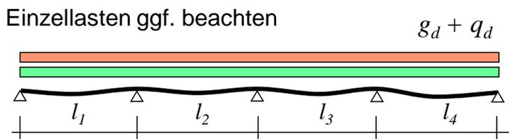
Bild 6-5 Vollbelastung für Querkräfte im üblichen Hochbau
