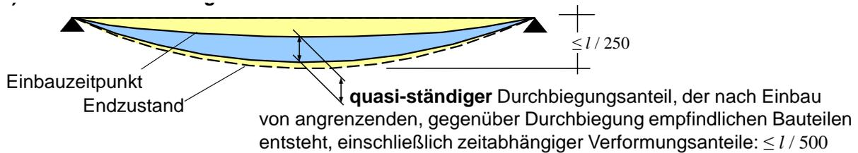
Bild 11-38 Begrenzung der Durchbiegung bei erhöhten Anforderungen
