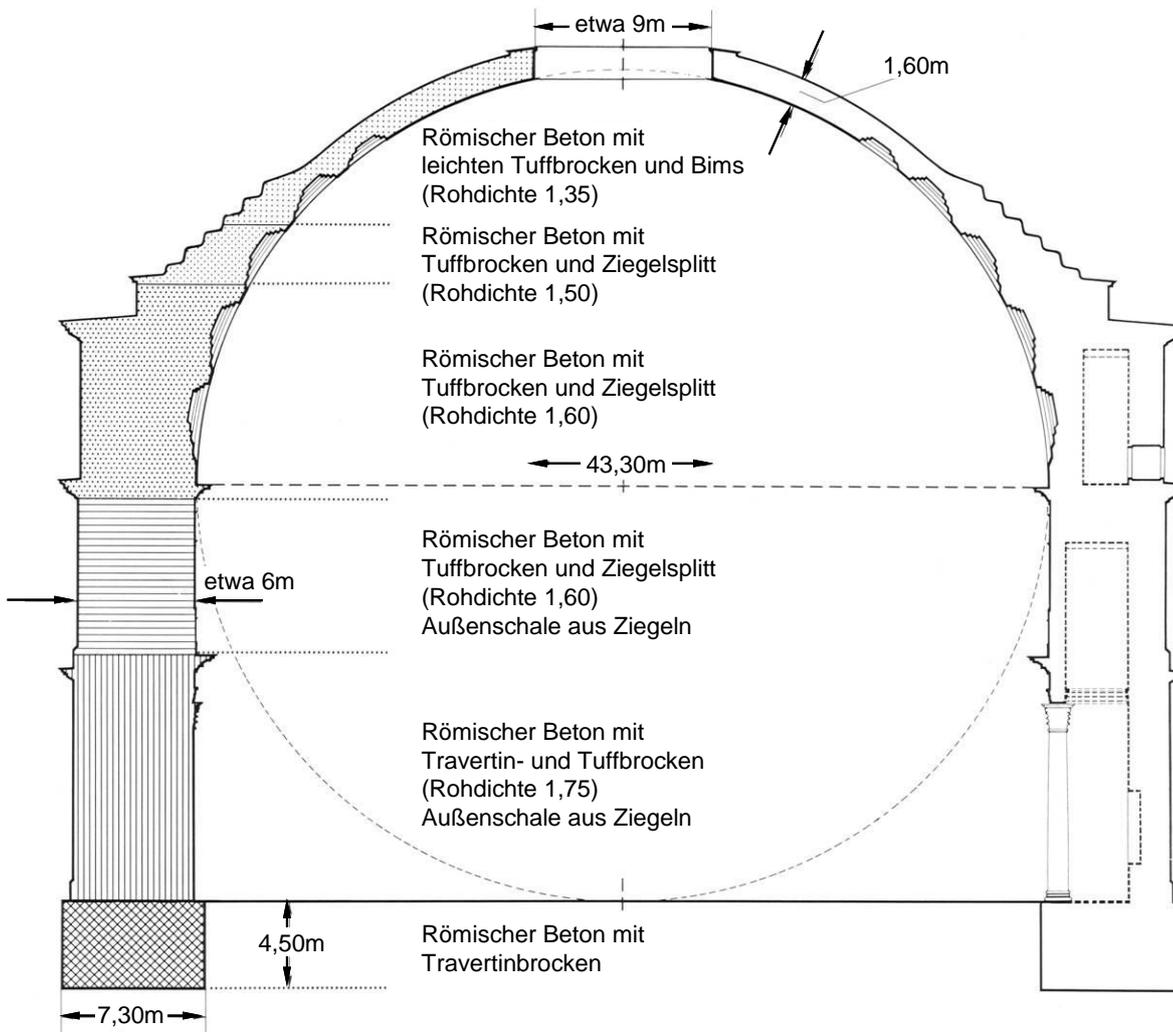
Bild 1-1 Pantheon in Rom; römischer Leichtbeton, Spannweite 43,30 m, 27 n. Chr., nach zweimaliger Zerstörung um 120 n. Chr. neu errichtet [1]
