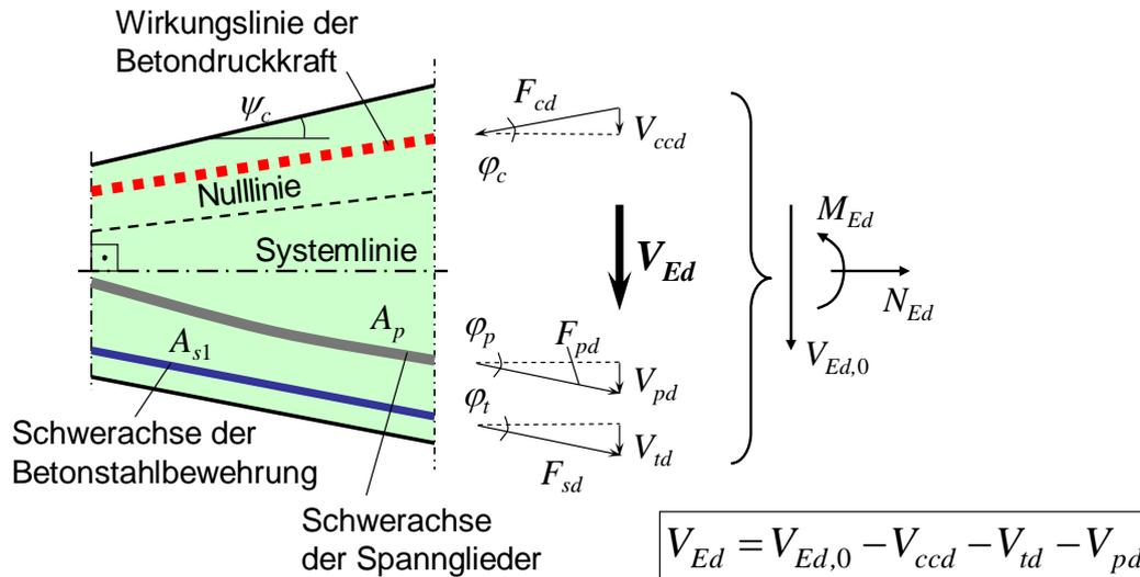
Bild 8-18 Bemessungswert der einwirkenden Querkraft bei Bauteilen mit veränderlicher Bauhöhe und/oder geneigter Spannbewehrung (alternativ kann der stat. best. Anteil der Vorspannung auch auf der Einwirkungsseite in Rechnung gestellt werden)
