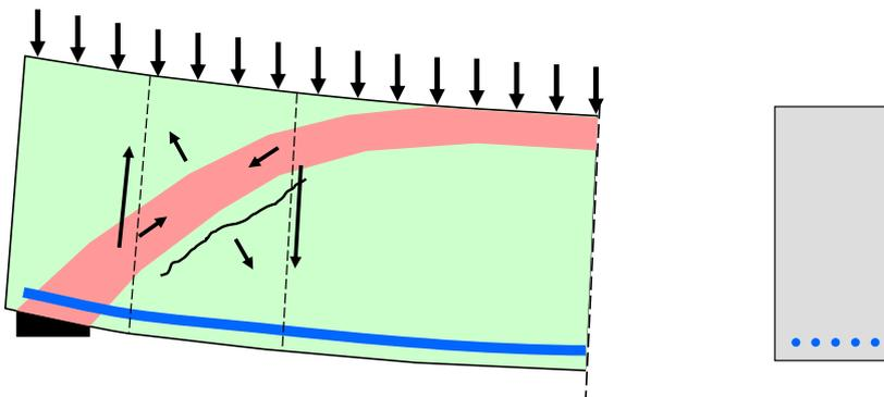
Bild 8-1 Entstehung eines schrägen Querkraftrisses am Auflager
