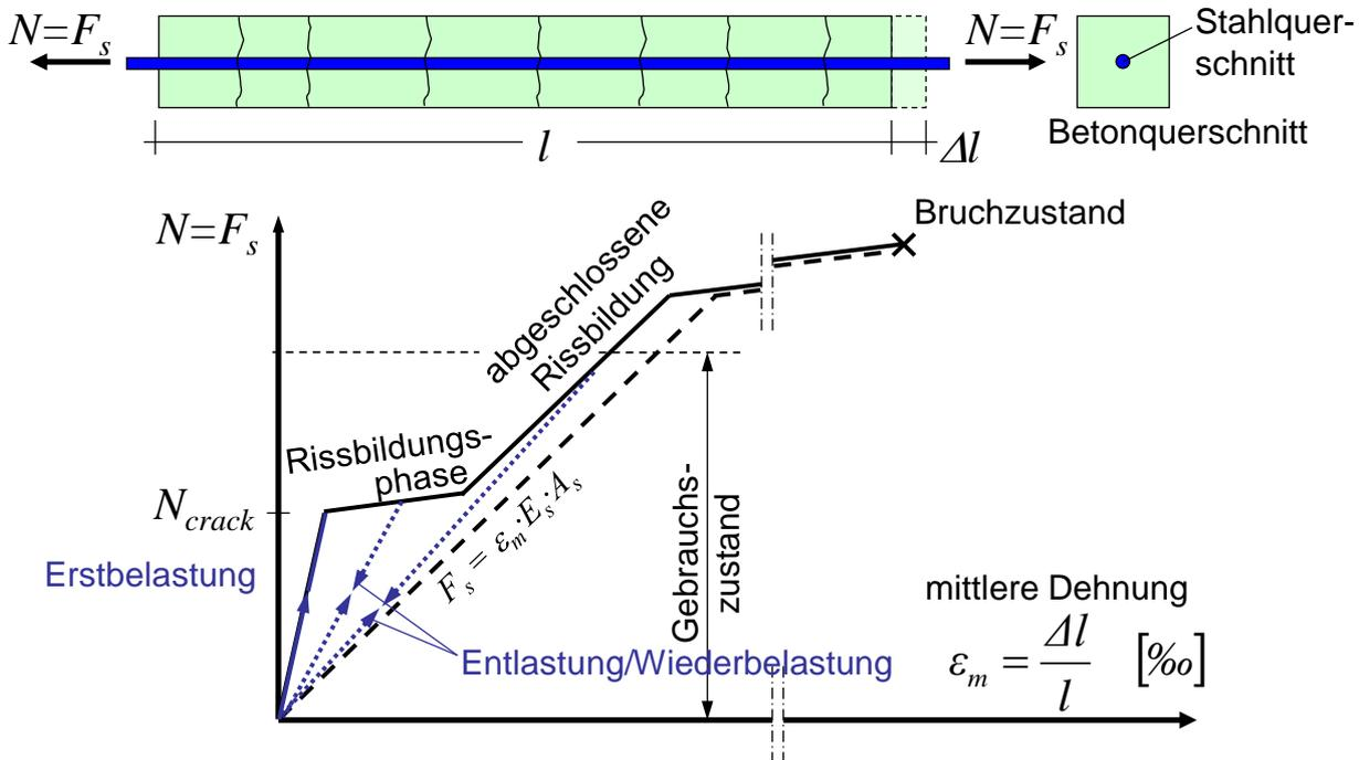
Bild 2-8 Arbeitslinie (Kraft-Dehnungs-Beziehung) eines Stahlbetonzugstabes
