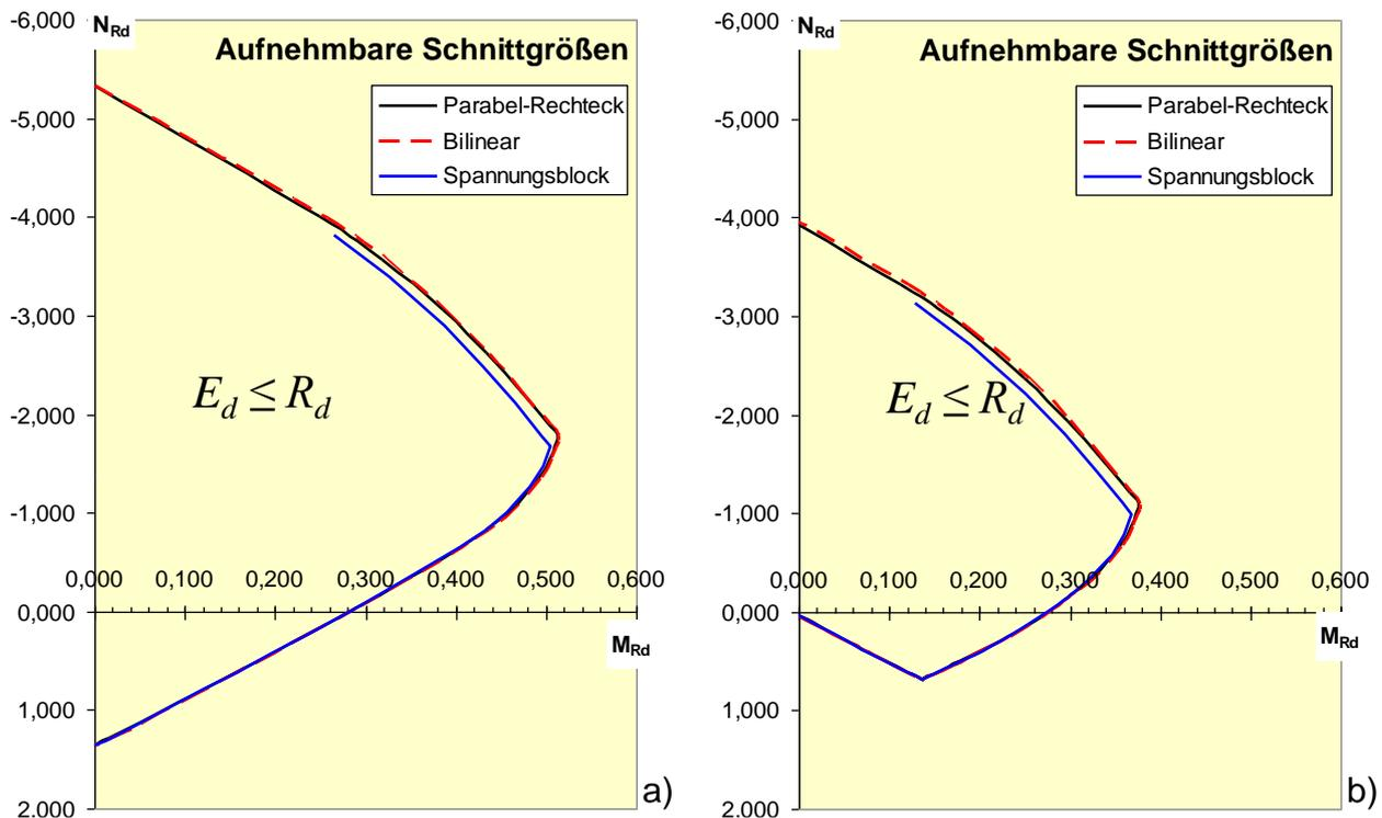
Bild 7-16 Bemessungsumhüllende für einen Rechteckquerschnitt a) symmetrisch bewehrt ( $A_{s1} = A_{s2} = 15,7 \text{ cm}^2$ ) und b) einfach bewehrt ( $A_{s1} = 15,7 \text{ cm}^2$ ). Weitere Angaben:  $b = 40 \text{ cm}$ ,  $h = 50 \text{ cm}$ ,  $d_1 = d_2 = 5 \text{ cm}$ , C35/45, ständige/vorübergehende Bemessungssituation
