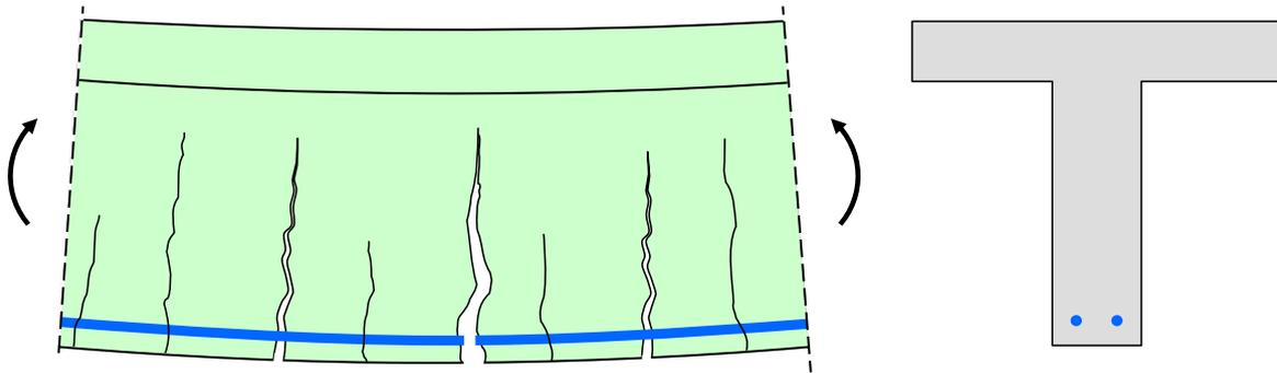
Bild 2-11 Biegezugbruch: übermäßige Dehnung in der Zugzone (erkennbar durch sich weit öffnende Risse) ohne oder mit Bruch der Bewehrung
