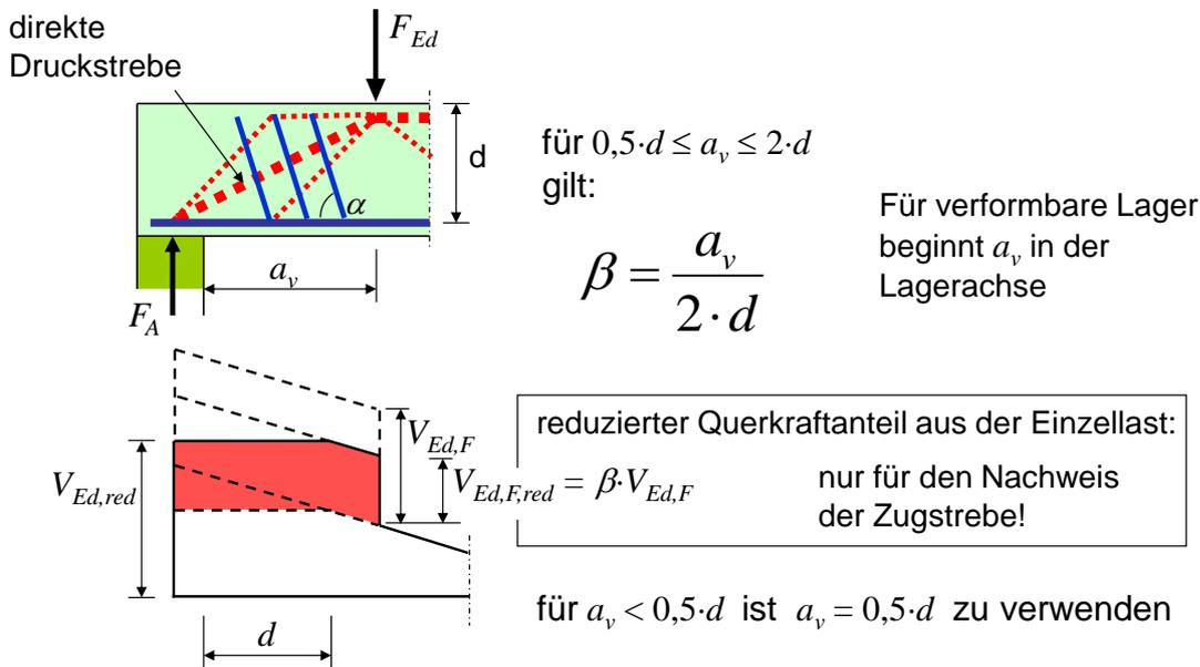
Bild 8-21 maßgebende Querkraft bei auflagernaher Einzellast
