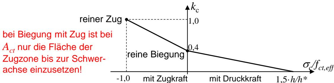
Bild 11-24 Beiwert  $k_c$  bei Biegung mit Normalkraft,  $h^* = h$  für  $h < 1,0m$ ,  $h^* = 1,0m$  für  $h \geq 1,0m$
