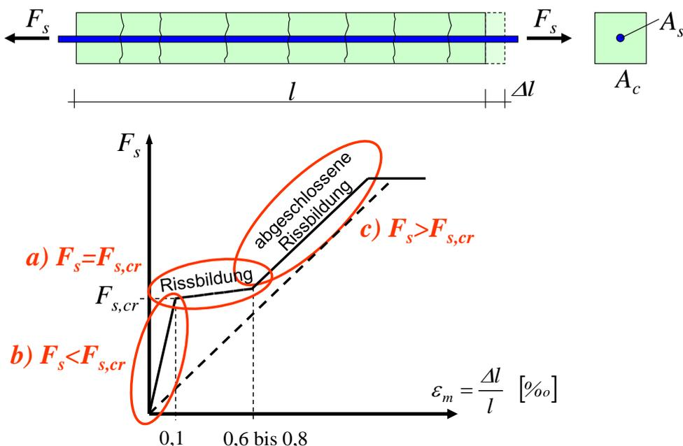
Bild 11-29 Kraft im Stahl in den verschiedenen Bereichen
