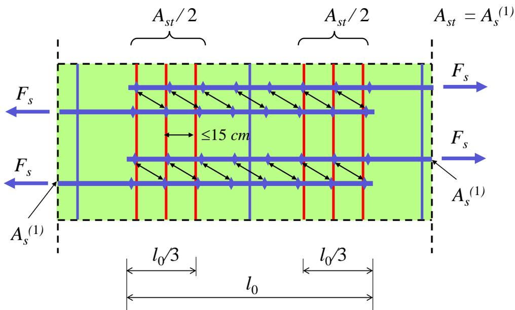
Bild 12-11 Größe und Verteilung der Querbewehrung eines Zugstoßes
