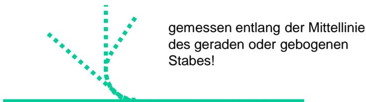
Bei gebogenen Zugstäben ist  $l_{bd}$  dann aufgrund eines kleineren  $\alpha_1$ -Wertes geringer.
