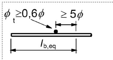
mit **einem** angeschweißtem Querstab  $\alpha_1 = 1,0$
