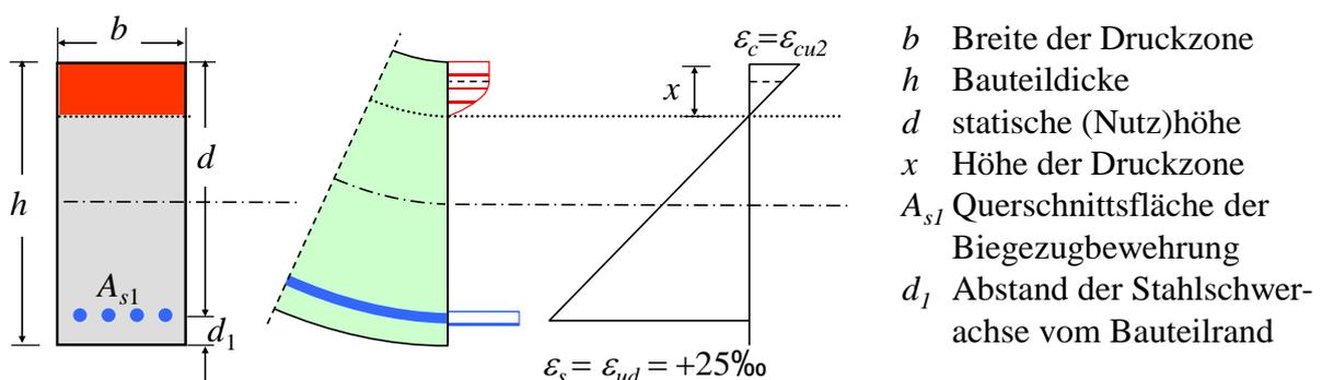
Bild 7-1 Grenzdehnungsverlauf, auf der Druckseite wird die Grenzdehnung des Betons ( $\epsilon_{cu2} = -3,5\text{‰}$  bis C50/60), auf der Zugseite wird die Grenzdehnung des Betonstahls erreicht, für  $\epsilon_{cu2}$  und  $\epsilon_{su}$  siehe Bild 5-4 und Bild 5-6
