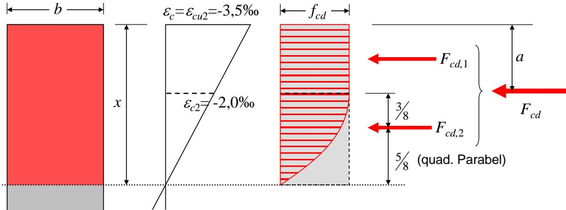
Bild 7-4 Ermittlung der resultierenden Druckkraft und ihres Randabstandes für einen Querschnitt mit rechteckförmiger Druckzone bei Ansatz des Parabel-Rechteck-Diagramms nach Bild 5-4, Grenzzdehnung des Betons wird am oberen Rand erreicht, Zahlenwerte bis C50/60,  $\epsilon_{cu2}$  und  $\epsilon_{c2}$  nach Bild 5-4
