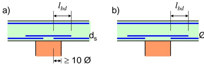
Bild 13-11 Verankerung an Zwischenauflagern
