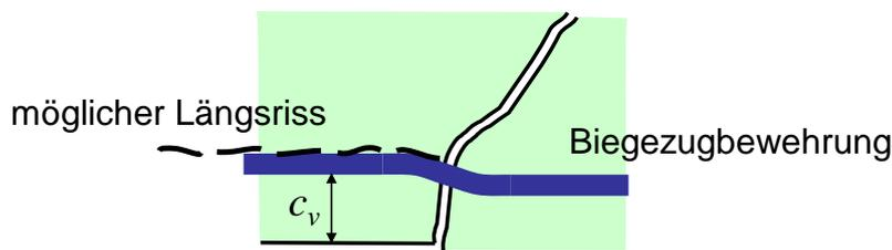
Bild 8-16 Dübelwirkung der Biegezugbewehrung
