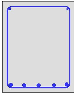
Es wird zunächst angenommen, dass der Betonstahl mindestens bis zur Streckgrenze ausgenutzt werden kann. Die aufnehmbare Zugkraft aller Stahleinlagen beträgt dann:
