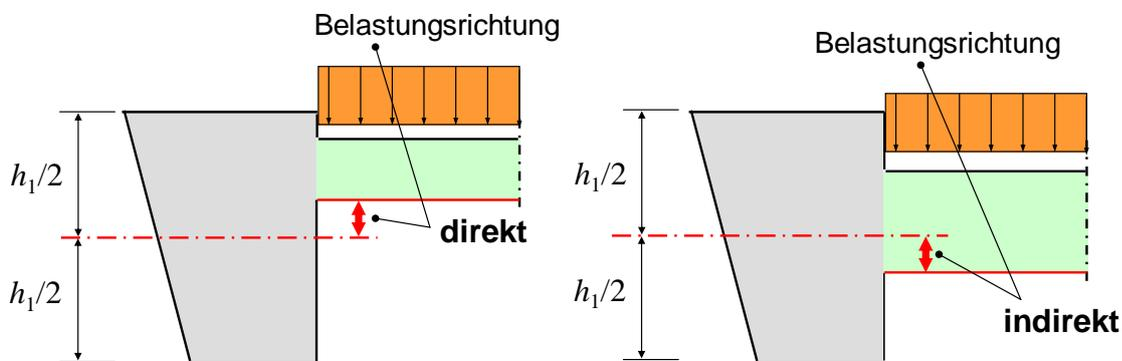
Bild 8-20 Abgrenzung zwischen direkter und indirekter Lagerung bei Auflagerung auf einem Biegebauteil
