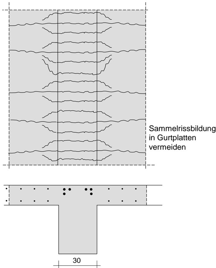
Bild 11-32 Sammelrissbildung in Zuggurtplatten eines Plattenbalkens
