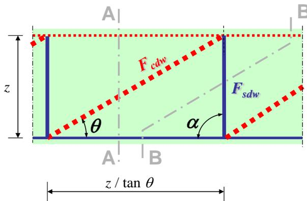
Bild 8-9 Fachwerkgeometrie bei Verwendung senkrechter Querkraftbewehrung
