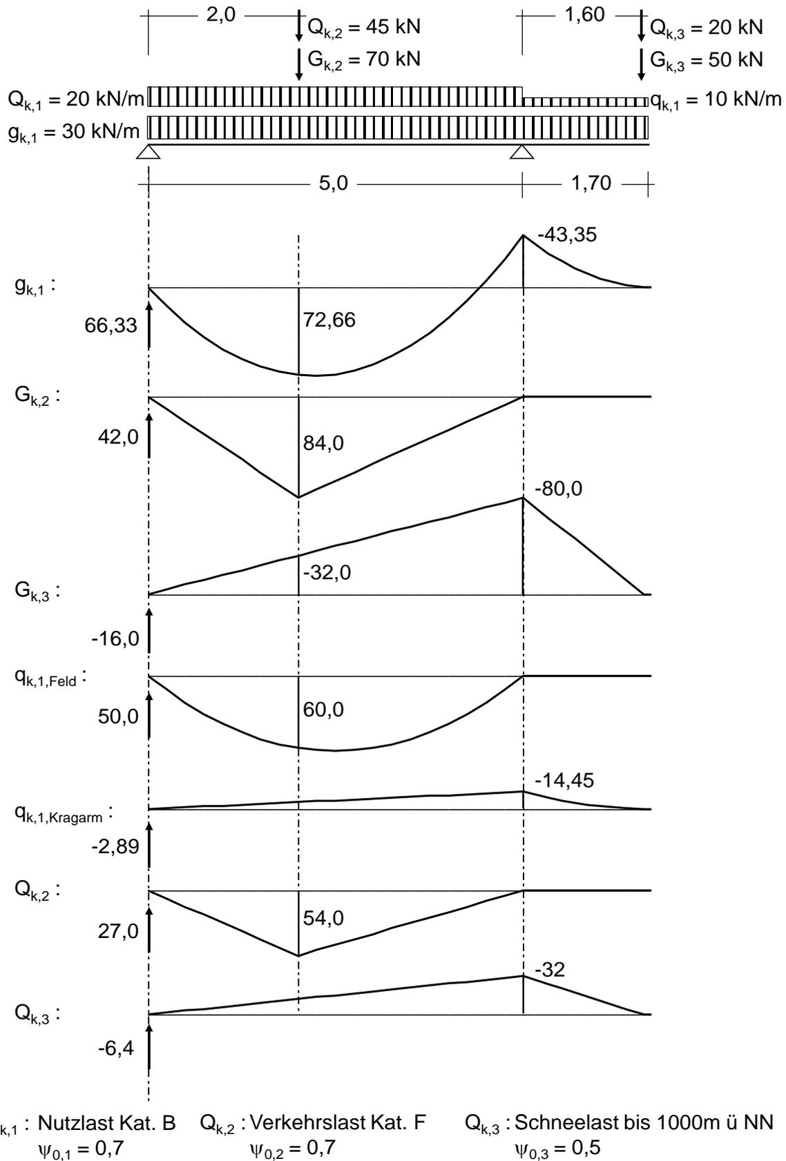
Im Folgenden wird im Grenzzustand der Tragfähigkeit für die ständige Bemessungssituation das betragsmäßig größte Stützmoment (minimales Stützmoment) sowie das maximale Feldmoment an der Stelle der Einzellasten im Feld berechnet. Die Überprüfung, ob tatsächlich an der Stelle der Einzellasten das maximale Feldmoment wirksam ist, wird im Rahmen dieses Beispiels als gegeben vorausgesetzt. Anschließend wird nachgewiesen, dass die Sicherheit gegen Abheben am Auflager A ausreichend ist.
