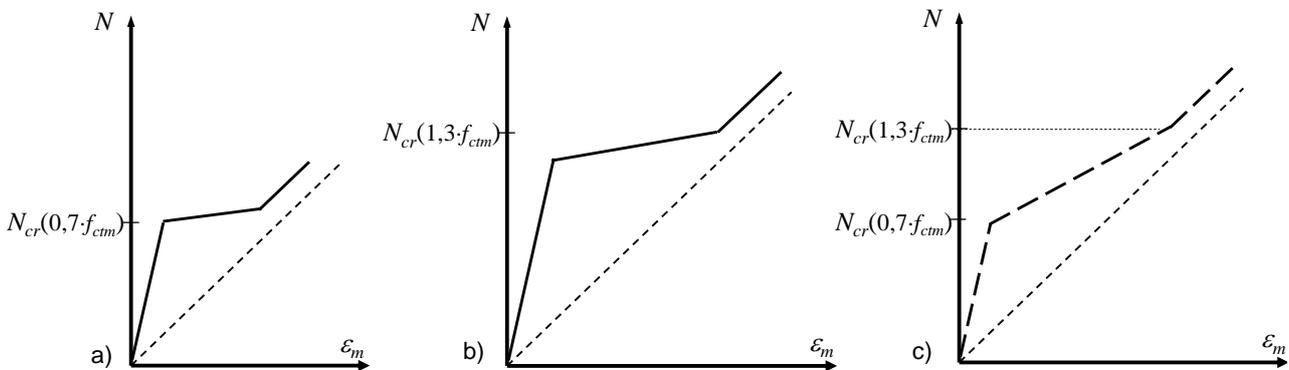
Bild 11-6 Einfluss der Streuung der Betonzugfestigkeit bei gleicher Betonfestigkeitsklasse
