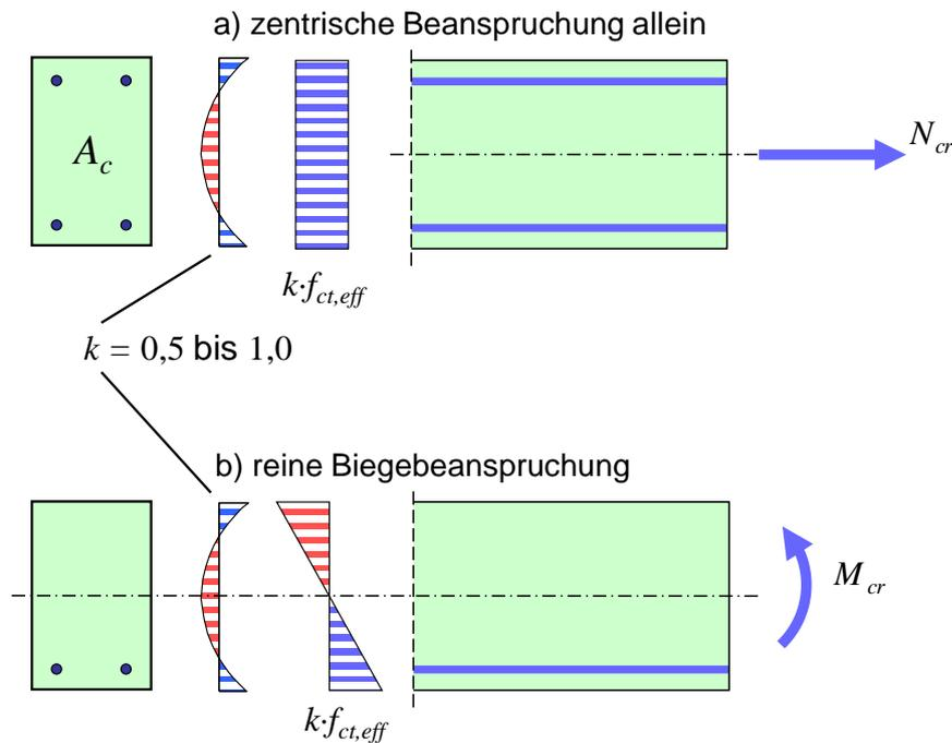
Bild 11-4 Risschnittgrößen für Normalkraft oder Biegung allein
