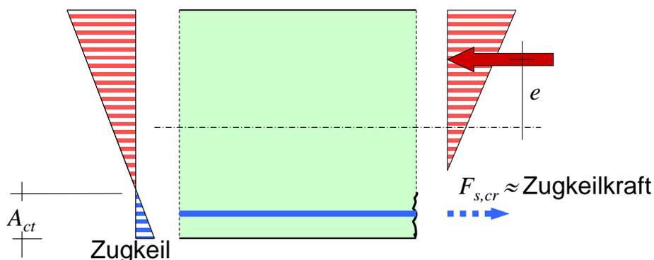
Bild 11-25 Bestimmung der Stahlkraft im gerissenen Zustand aus der Zugkeilkraft nach Zustand I
