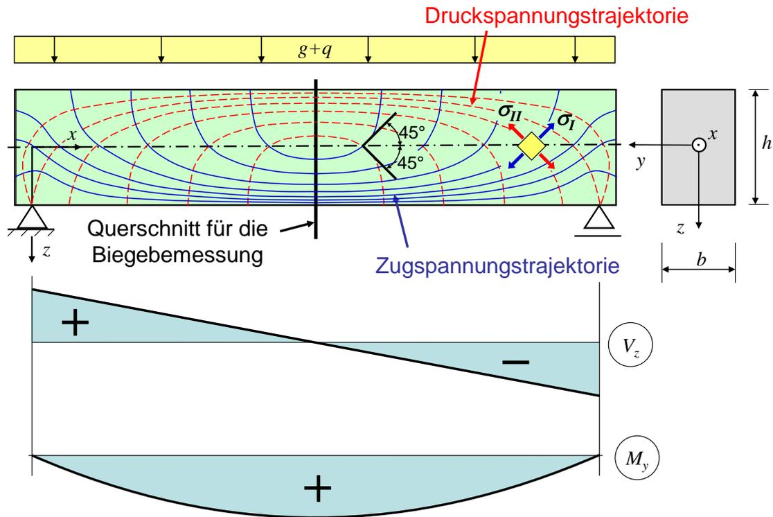
Bild 8-7 Verlauf der Hauptspannungen in einem ungerissenen Bauteil
