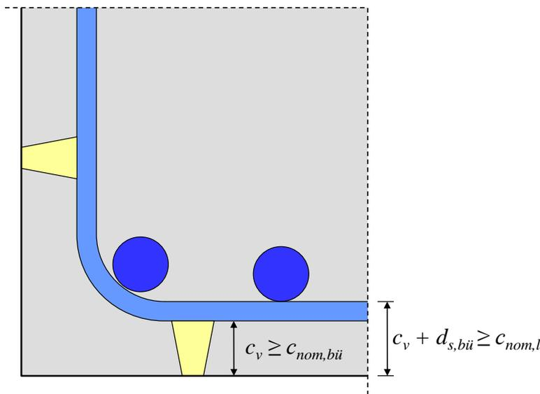
Bild 4-3 nominaler Wert und Verlegemaß der Betondeckung von Längs- und Bügelbewehrung eines Balkens bzw. einer Stütze
