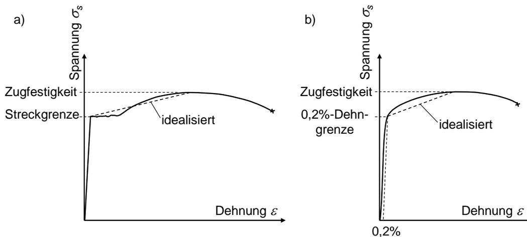
Bild 2-5 Typische Spannungs-Dehnungs-Diagramme für
