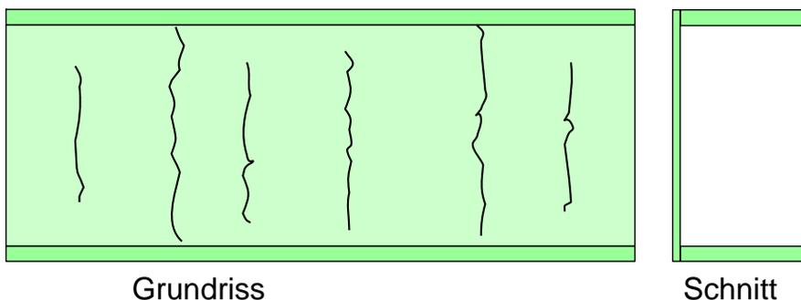
Bild 11-11 Rissbildung in einer in Längsrichtung verformungsbehinderten Decke
