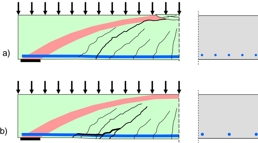
Bild 8-6 Querkraftversagen von Bauteilen ohne Querkraftbewehrung (bei Platten zulässig)
