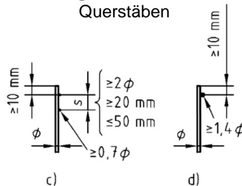
für c) und d) darf i.d.R. die Betondeckung nicht weniger als  $3 \cdot \varnothing$  oder 50mm betragen
