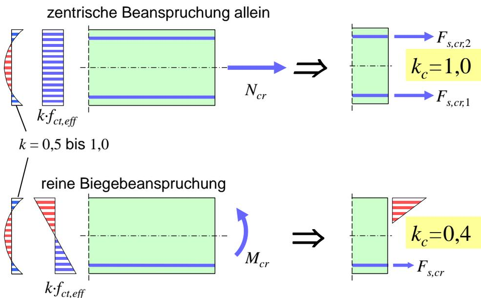
Bild 11-23 Stahlkräfte im Riss unter Rissschnittgrößen für zentrische Beanspruchung und alleinige Biegebeanspruchung
