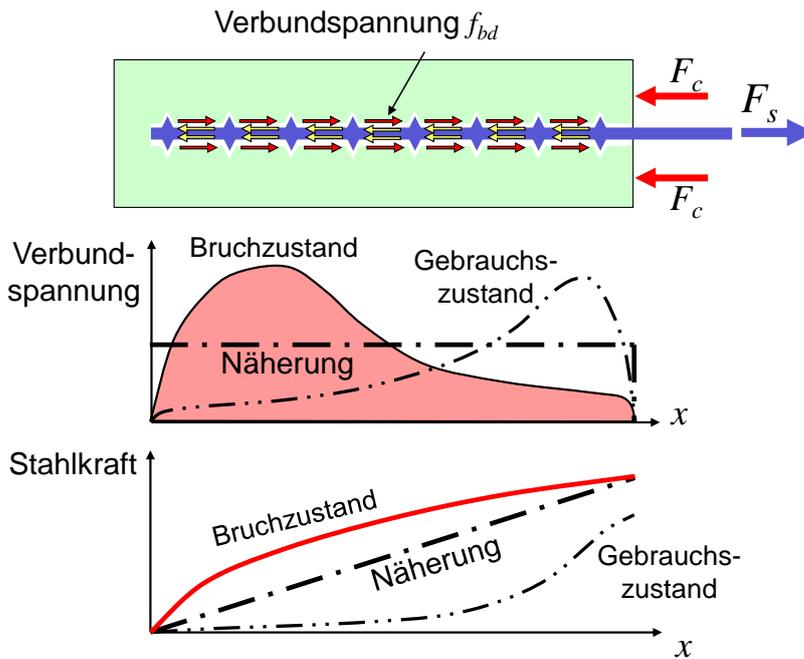
Bild 12-2 Verlauf der Verbundspannungen entlang einer Verankerung
