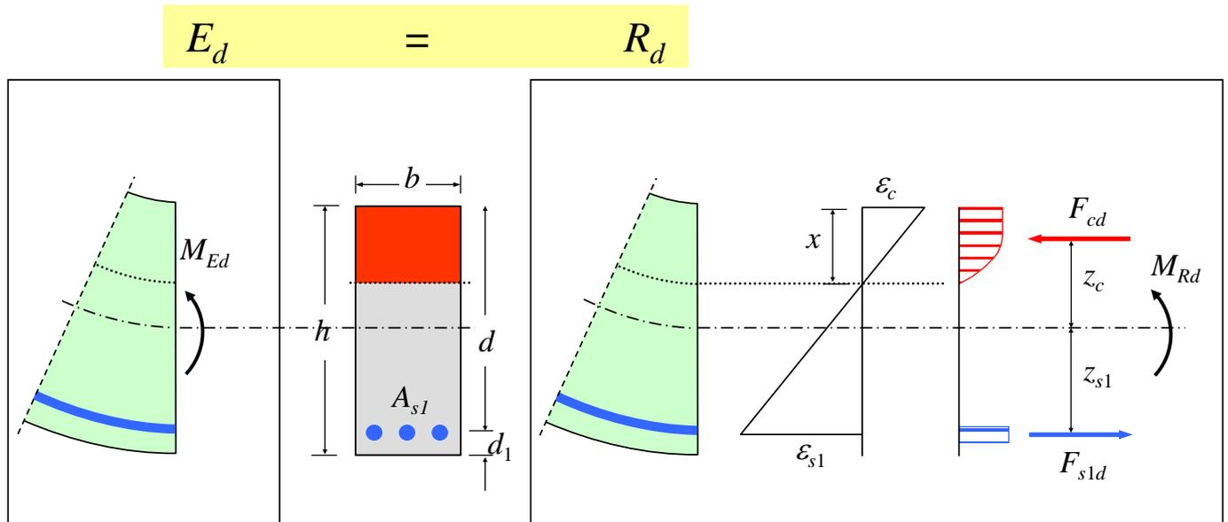
Bild 7-7 Dehnungen, Spannungen, resultierende Kräfte, aufnehmbares Moment
