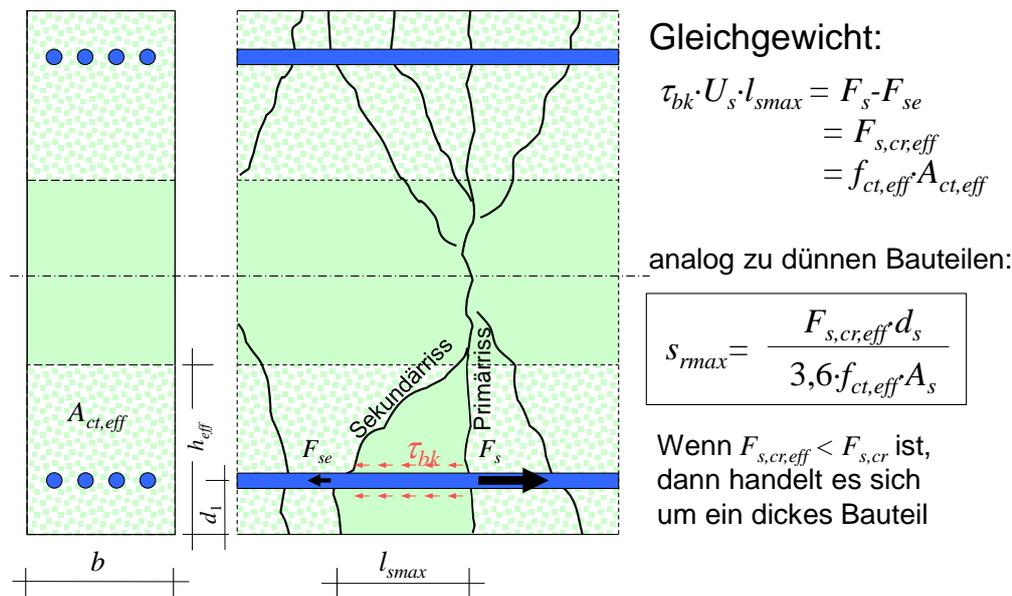
Bild 11-30 Ermittlung des Rissabstandes bei dicken Bauteilen
