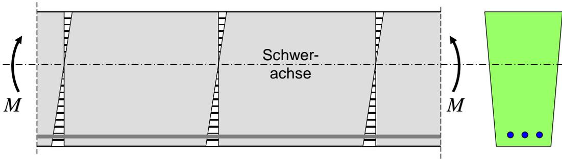
b)  $M = M_{crack}$ : Betonspannungen im Zustand I / Zustand II
