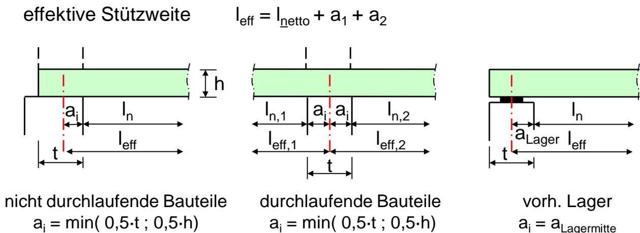
Bild 6-1 Lage der rechnerischen Auflagerachsen, EC2, Bild 5.4
