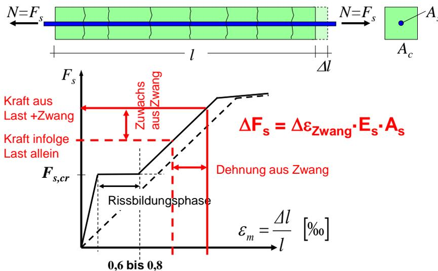
Bild 11-35 Kombination von Last und Zwang für zentrisch beanspruchte Bauteile
