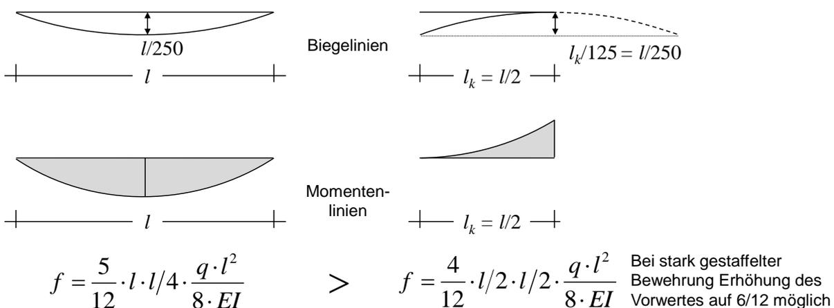
Bild 11-43 Vergleich der Durchbiegungen von Einfeld- und Kragssystemen
