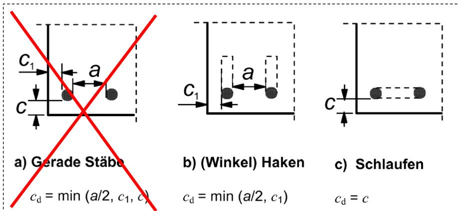
$$l_{b,eq} = \alpha_1 \cdot \alpha_3 \cdot \alpha_4 \cdot \alpha_5 \cdot l_{b,rqd} \geq l_{b,min} \quad \text{ggf. Erhöhung bei Querkzug oder Abminderung an direkten Auflagern (s.o.)}$$
