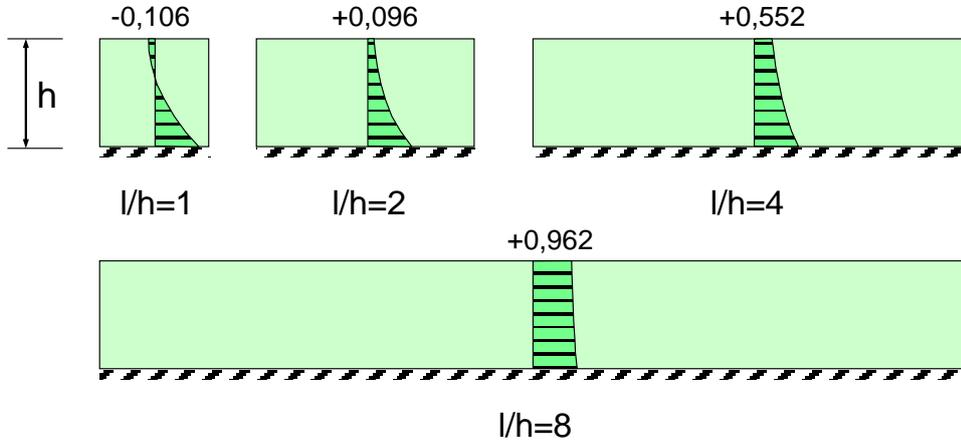
Bild 11-8 Horizontale Zugspannungen nach Elastizitätstheorie in einer am unteren Rand verformungsbehinderten Scheibe für verschiedene Seitenverhältnisse nach *Schleeh* [15]
