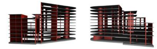
Wände für vertikalen und horizontalen Lastabtrag
