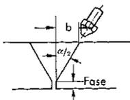
Abb. 13. Von der Blechdicke wird die gewünschte Faserhöhe der Nahtwurzel subtrahiert und mit dem Tangens des halben Nahtwinkels  $\text{tg}(\frac{\alpha}{2})$  auf der Quadranteilung multipliziert, wozu die Marken für  $\text{tg}(\frac{\alpha}{2})$  auf der linken Zungenteilung benutzt werden.
