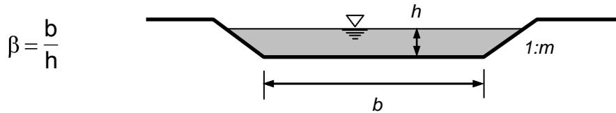
Der Fließquerschnitt, der hydraulische Radius, die Fließgeschwindigkeit und der Abfluss werden jeweils als ein Vielfaches der Breite  $b$  bzw. einer Potenz davon dargestellt. Dieses Vielfache ist eine Funktion der Geometrieparameter  $\beta = b/h$  und  $m$ .
