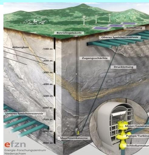
Abbildung 2 Unterflurpumpspeicherwerk
