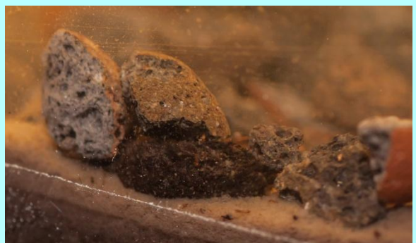
2: Gebrochener Blähton "schwimmt" auf der Weichschicht
