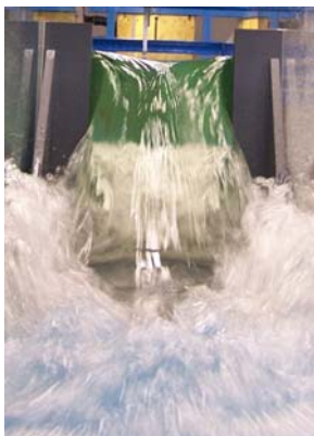
Abb. 1: Blick auf den scharfkantig senkrechten, rechteckig eingeeigten Überfall
