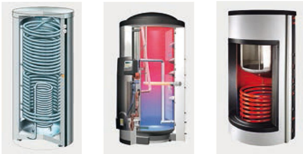
Abbildung 2.25: Solarspeicher mit verschiedenen Arten der Brauchwassererwärmung: innenliegender Trinkwasserwärmetauscher, externe Frischwasserstation, innenliegender Brauchwasserspeicher (v.l.n.r.) (BDH 2015b)
